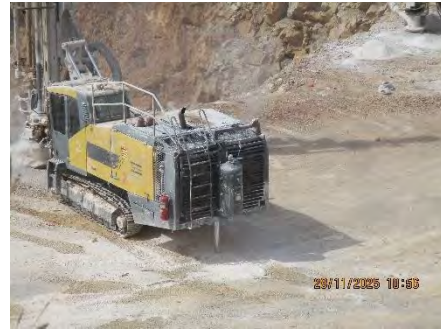
ภาพที่ 2-12 เครื่องเจาะระเบิดที่ติดตั้งเครื่องดักจับฝุ่นแบบถ่วงกรอง (Dust Collector)
