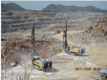
ภาพที่ 2-12 เครื่องเจาะระเบิดที่ติดตั้งเครื่องดักจับฝุ่นแบบถ่วงกรอง (Dust Collector)
