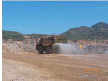
ภาพที่ 2-7 รถบรรทุกน้ำฉีดพรมน้ำเพื่อลดการฟุ้งกระจายของฝุ่นละออง
